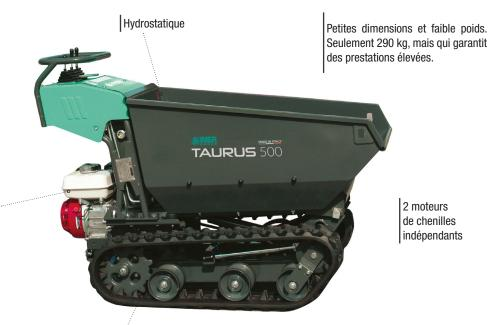
Equipé de 3 pompes qui permettent une utilisation indépendante du déchargement de la benne et de la pelle chargeuse de la traction
